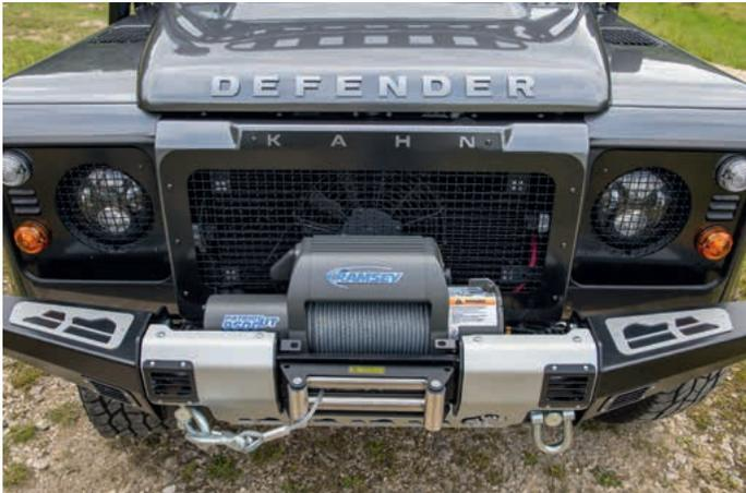
Massiv: Die Seilwindenstoßstange von Tembo4x4 beherbergt eine Ramsey-Winch. Vier verdeckt eingebaute LED-Arbeitscheinwerfer sorgen für Licht.
