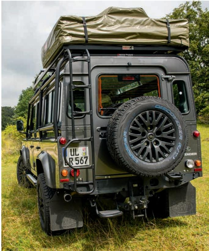
**Aufstieg:** Die Leiter von Safety Devices hilft nach oben zu kommen. Der Ersatzradhalter von Mantec ist schwenkbar und entlastet die Tür.
