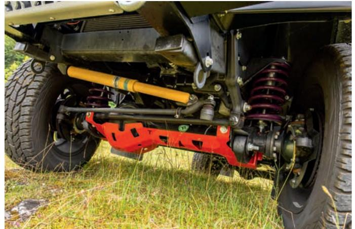
Geländegängig: Fahrwerk und Lenkungsdämpfer sorgen für mehr Höhe und Fahrkomfort. Differential und Achsrohr sind gut geschützt.
